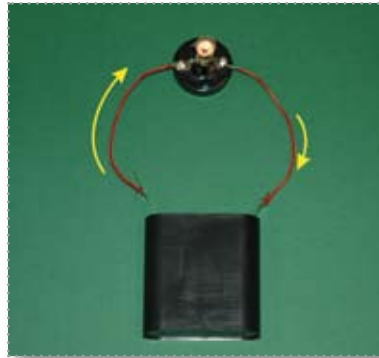
Abbildung 2b: Verbrauchsvorstellung. Hinter dem Lämpchen fließt ein geringerer Strom als in der Hinleitung, wobei sich als Variante auch die Qualität der Substanz verändern kann.
