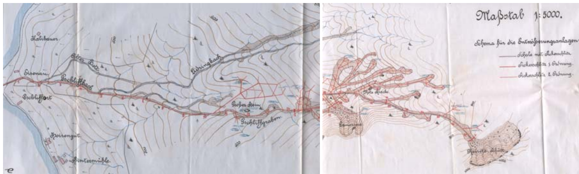
Abb. 9c, d: Der Projektentwurf eines flächenhaften, allerdings nie verwirklichten Drainagesystems im Gschlifgraben nach Pokorny (1894).
