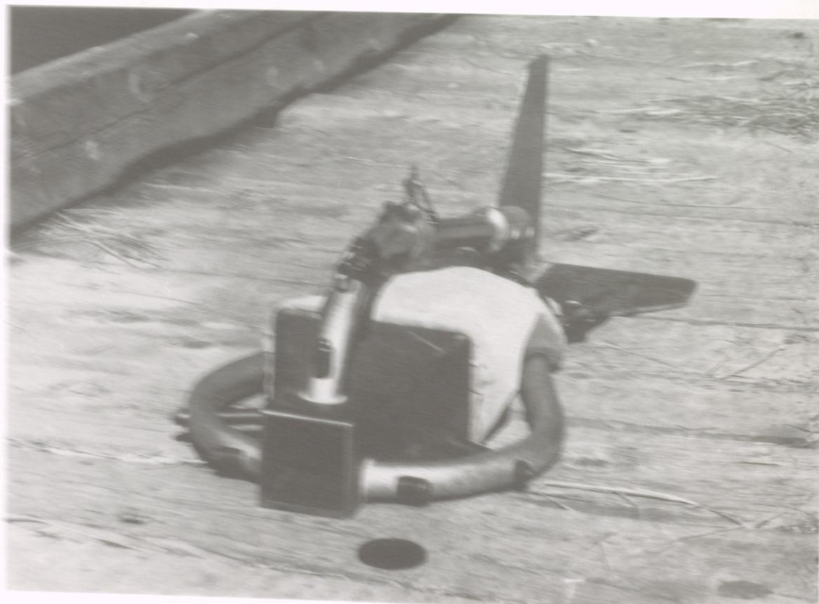
Abb. 15.17 Die am schwierigsten zu messende Komponente der Flussfracht ist die Geschiebefracht. Der Helley-Smith Bedload Sampler ist eigens zu diesem Zweck entwickelt worden.
