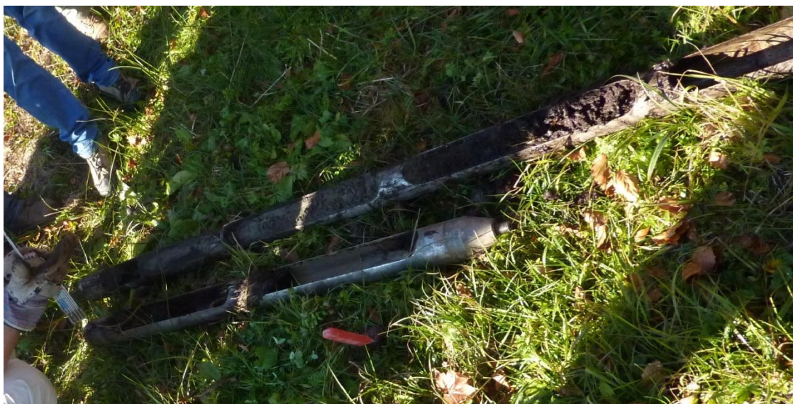
Wie man sieht war der erste Bohrkern zu flüssig. (Im Bild der untere Kern)
