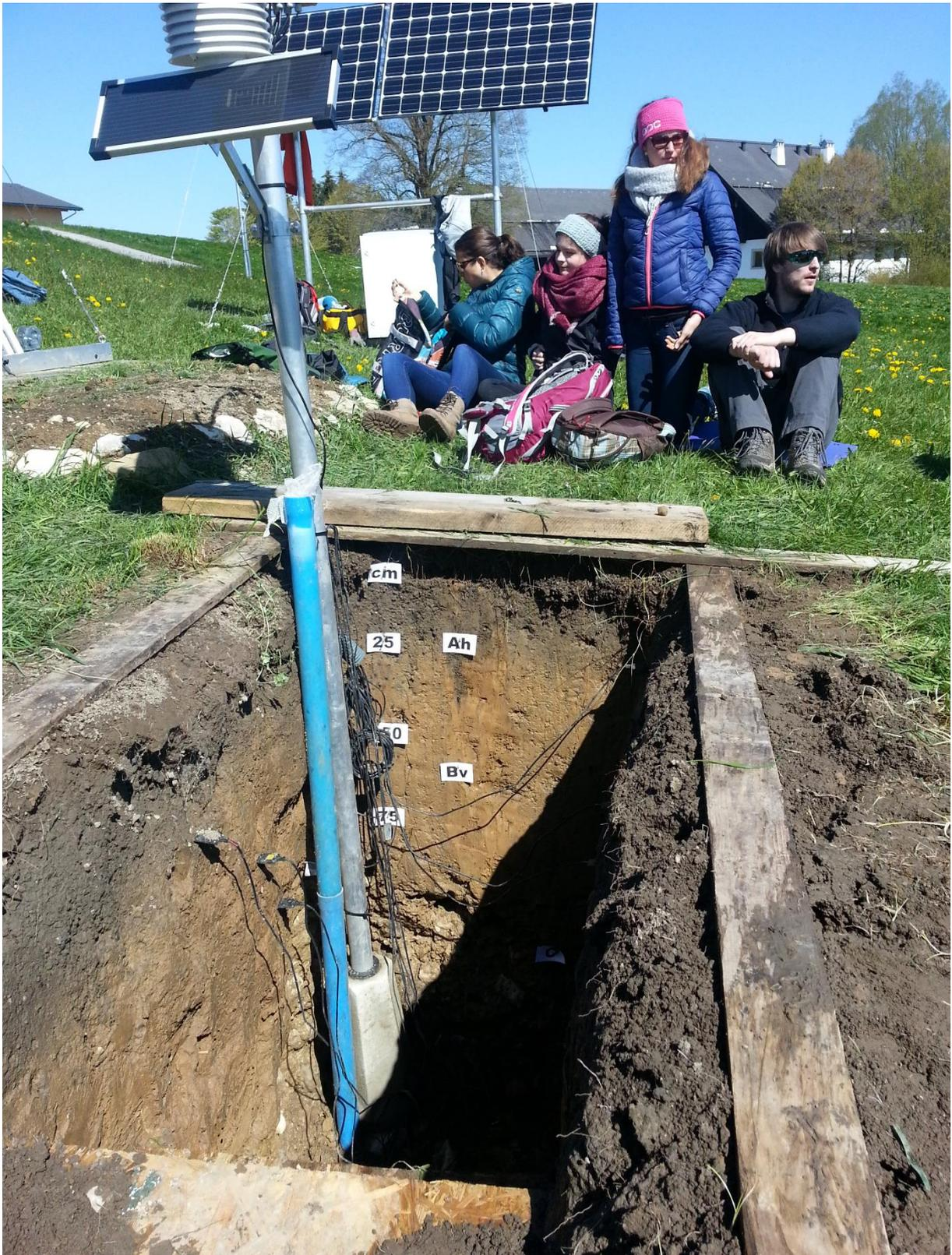
Abbildung 20: Der Bodenaufschluss bis zur Grundmoräne
