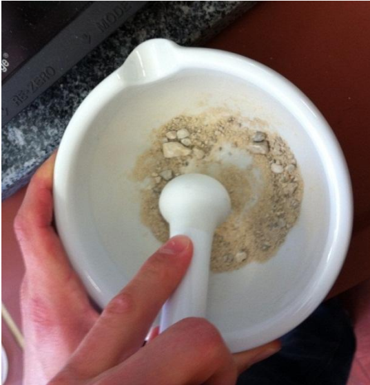
Abb.13: Scheibler-Methode Einwaage zerkleinern
