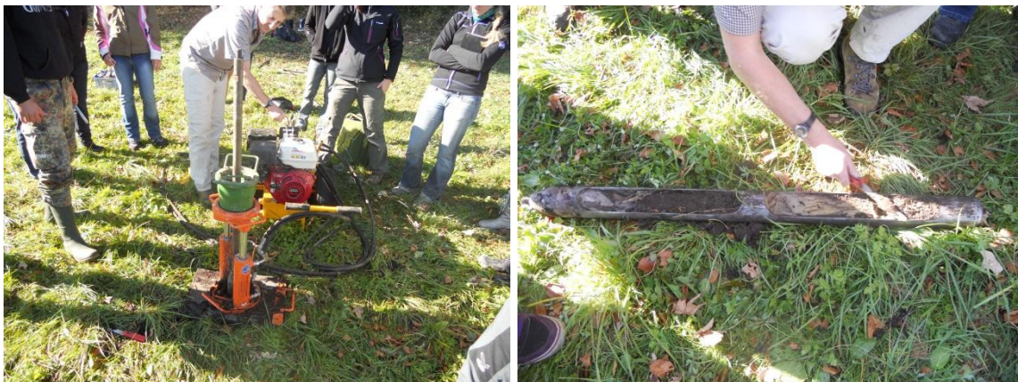
Abb.5: Sondierstange Entnahme im Gelände
