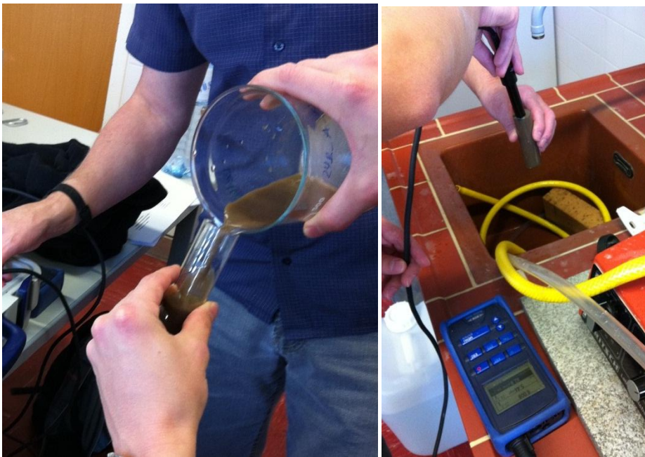
Abb.15: Messung der Bodenprobe mit pH-Messgerät
