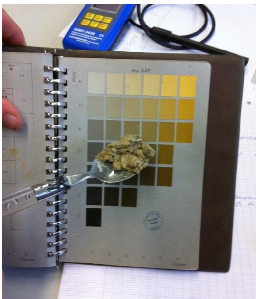
Abb.16: Farbbestimmung mittels Farbkatalog
