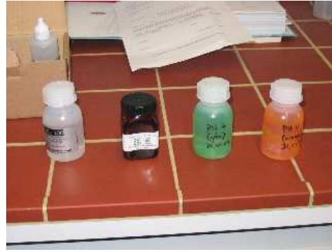
Abb. 13: GKL 100, Redox-Prüflösung und Eichlösungen pH-Wert 7,0 und 4,0
