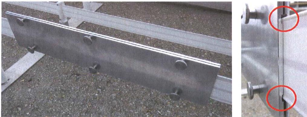
Nach dem Befestigen der Platten werden nochmals die C-Werte gemessen. Diese müssen nun um einen definierten Wert angestiegen sein. Der Anstiegswert unterscheidet sich bei den verschiedenen Bandlängen.
